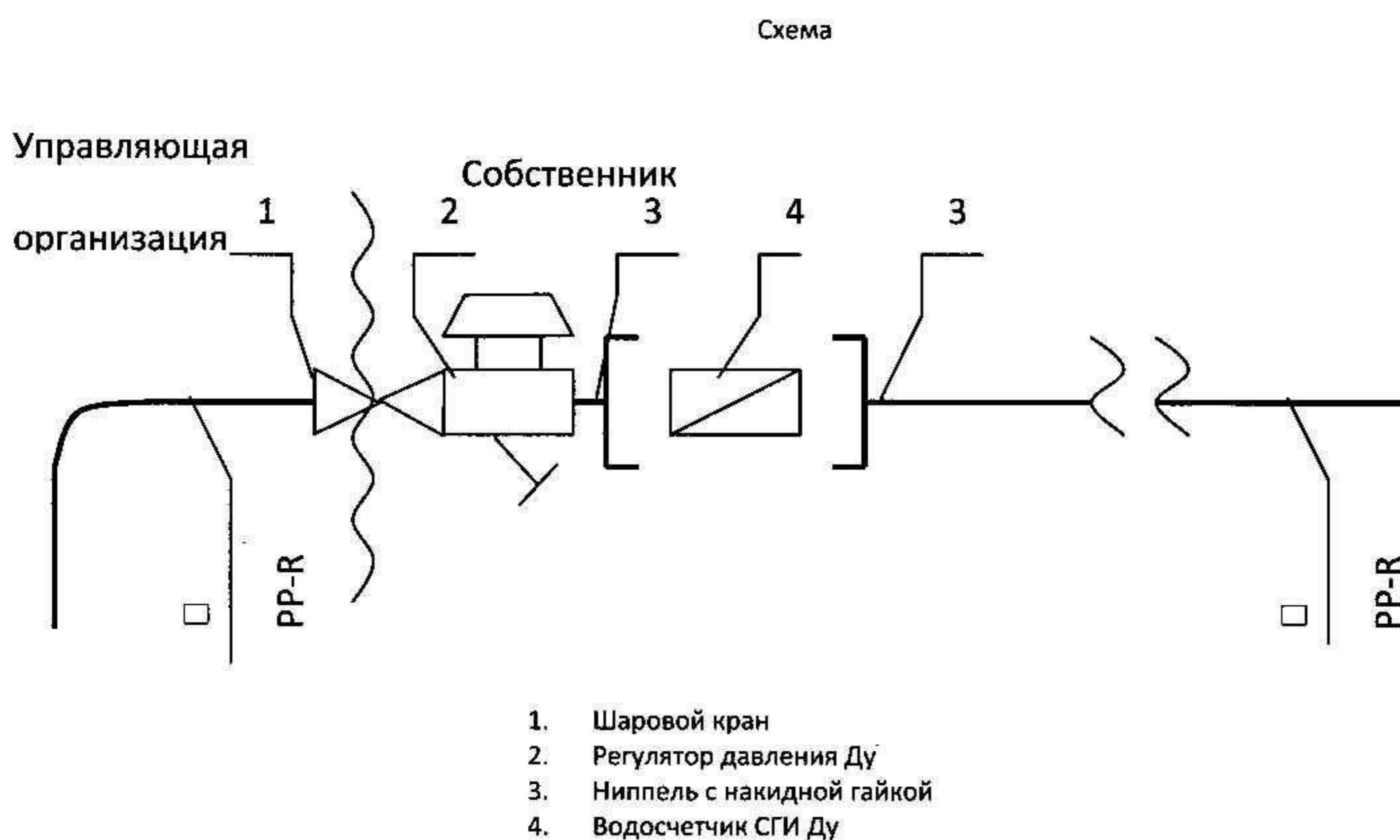
Исполнитель несет ответственность за надлежащее состояние и работоспособность систем горячего и холодного водоснабжения согласно нижеуказанной схеме до волнистой линии слева (включая шаровой кран)
