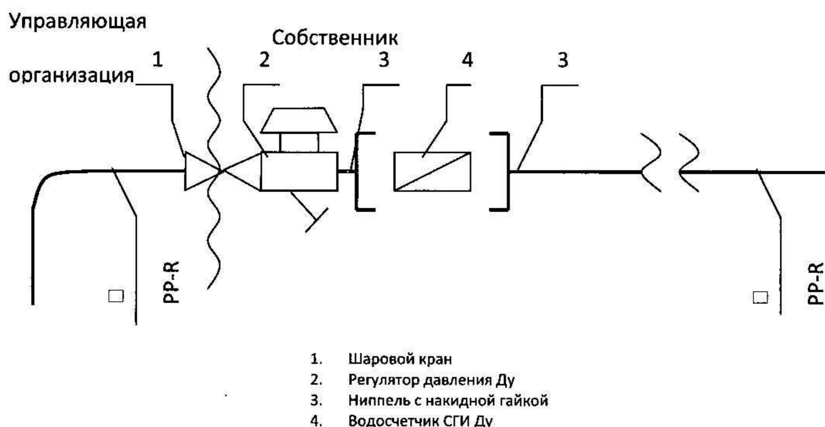
Исполнитель несет ответственность за надлежащее состояние и работоспособность систем горячего и холодного водоснабжения согласно нижеуказанной схеме до волнистой линии слева (включая шаровой кран)
