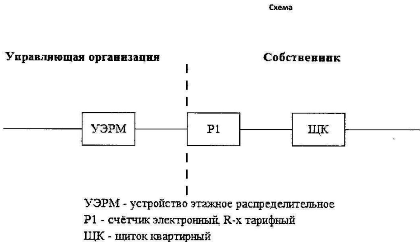
Исполнитель несет ответственность за надлежащее состояние и работоспособность питающих электрических сетей на квартиру согласно нижеуказанной схеме до прибора учета (пунктирной линии слева).
