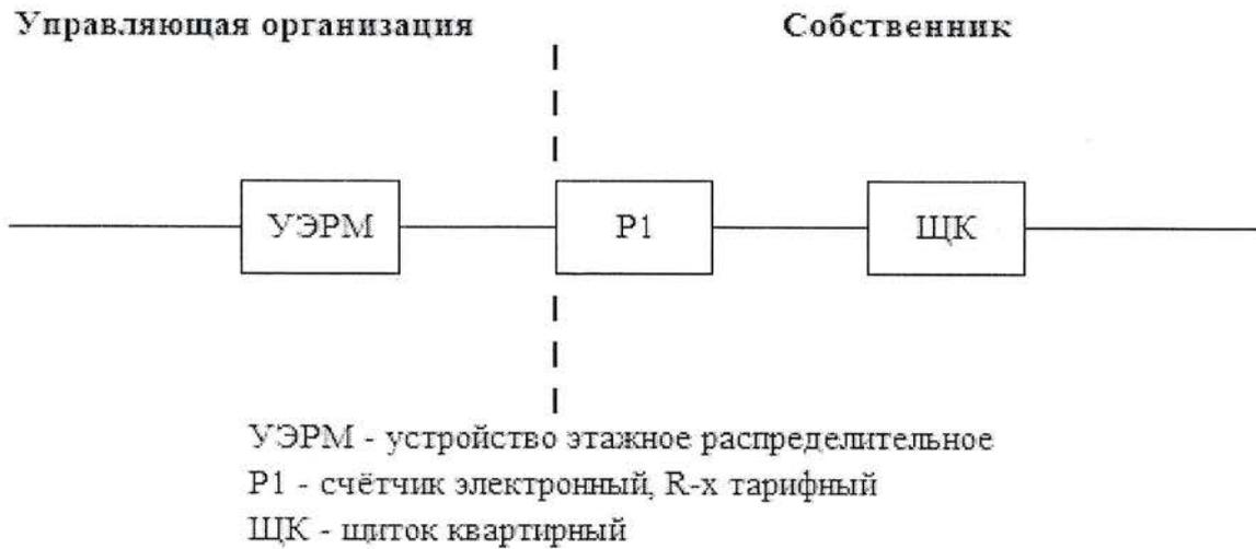
Управляющая организация несет ответственность за надлежащее состояние и работоспособность питающих электрических сетей на квартиру согласно нижеуказанной схеме до прибора учета (пунктирной линии слева).
